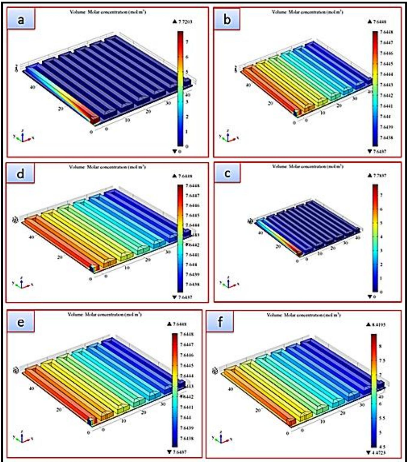
Fig. 2. Cathode Oxygen concentration at cell potential (a) 0.4V (b) 0.5V (c) 0.6V (d) 0.7V (e) 0.8V (f) 0.9V.
